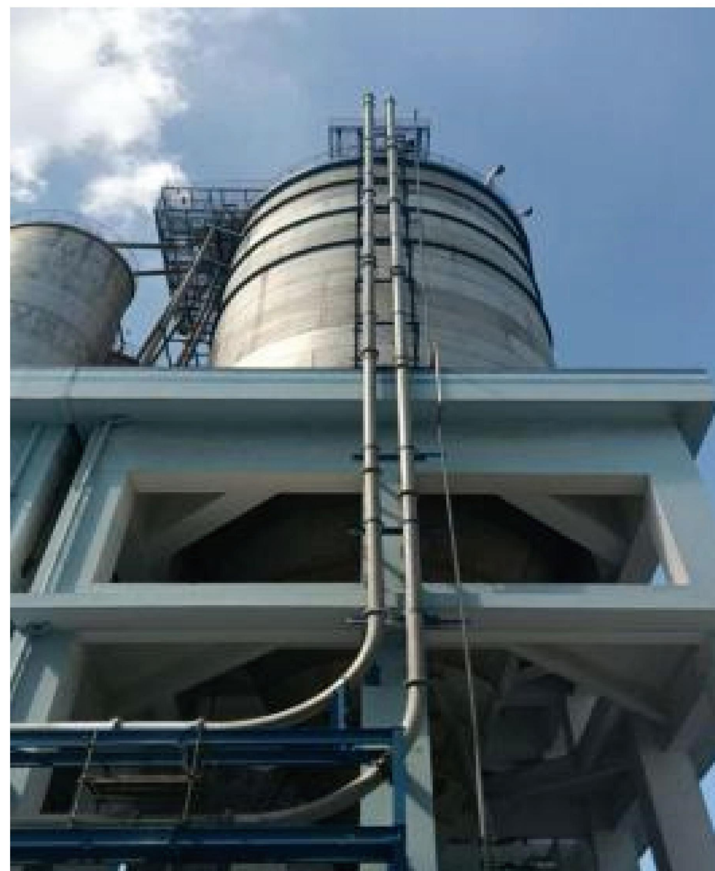
■ 输送能力180t/h，最大负荷200t/h，节能高效
