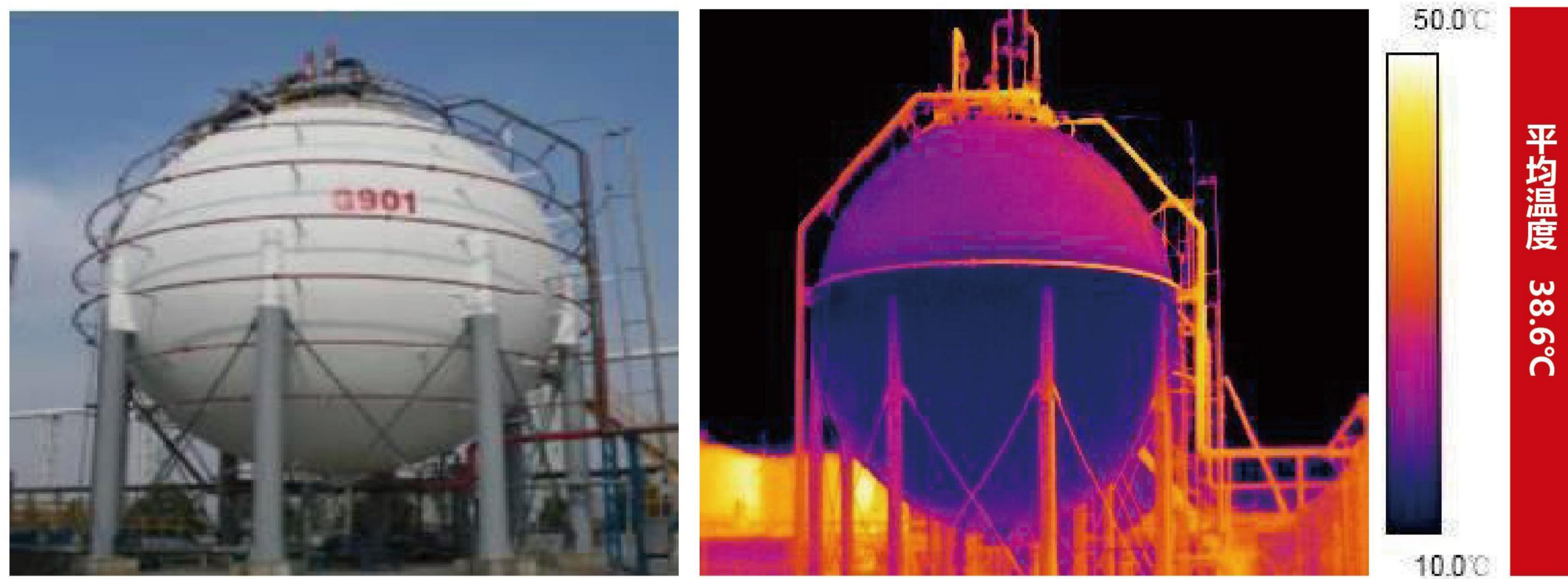
G901球罐（纳米涂料）表面温度场分布（红外热成像）
